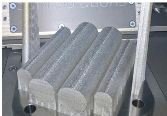
Eprouvettes d'essais mécaniques réalisées en titane recyclé
